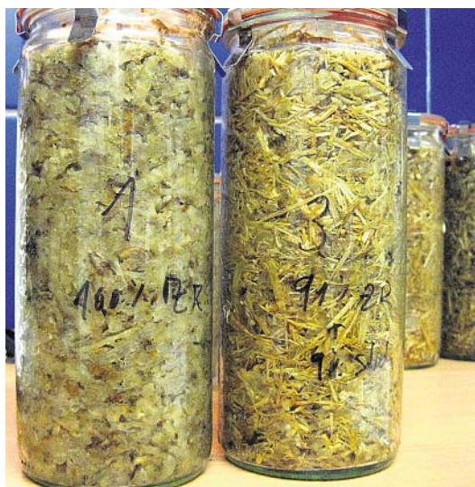
Silierungsversuche im Weckglas. Links Zuckerrüben ohne Stroh, rechts mit 9 % Stroh. Wichtig sind eine gleichmäßige Verteilung des Strohs und eine gute Verdichtung.
