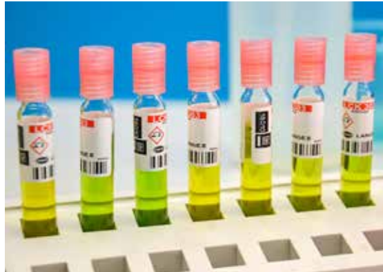
Photometrische Ammoniumbestimmung: Je grüner die Flüssigkeit, desto höher ist der Ammoniumgehalt.
