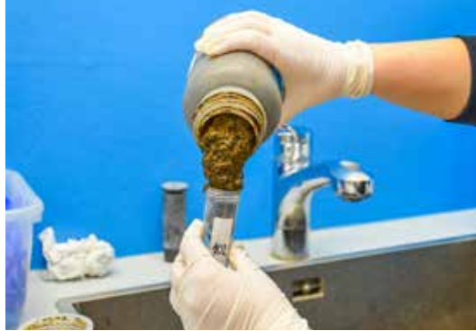
Die Fermenterprobe wird in ein Zentrifugenröhrchen umgefüllt. Fotos: Iris Jaeger
